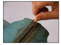
Draht ggf. umspannen und in die korrekte Lage biegen (Ebenheit).
