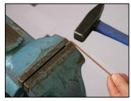
Erste Biegung: Den Hammer dicht am Schraubstock führen und den Draht scharfkantig biegen.
