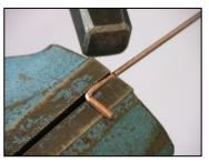
Draht flach einspannen. Den Hammer dicht am Schraubstock führen.
